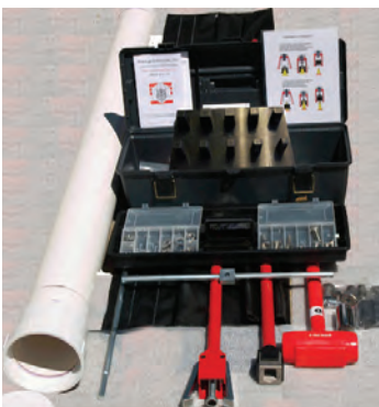
Outil de remplacement d'écrou d'opération sans excavation (vanne d'aqueduc)
