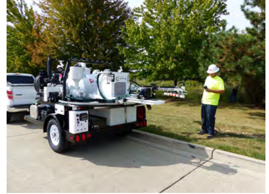
Manipulateur de vanne sur remorque Option de 800, 1500 ou 2500 lb de couple
